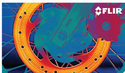
Ensayo de frenos de motocicleta
