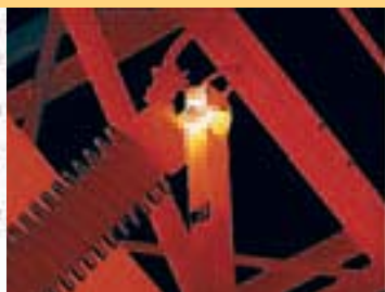
Conexiones mal fijadas
