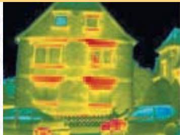
Puntos calientes por malos aislantes
