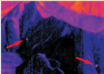
Identificación de zonas de incendio en una escombrera
