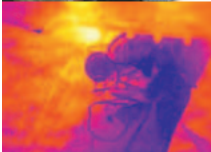
Imagen de vídeo IR de un atasco en el lado derecho del rodillo transportador
